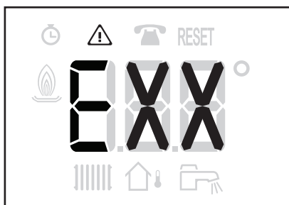
Fig. 123 Affichage des codes de défauts
